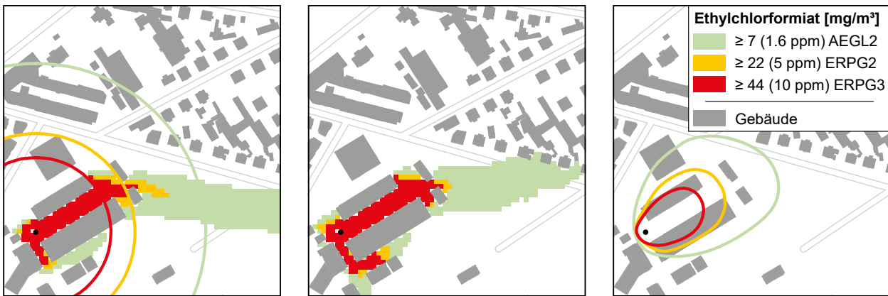
Abb. 1: Beispiel des Vergleichs der Ergebnisse der Berechnungen aus SAMS2 (LPRWND/LASAT; links) SAMS2 (MISKAM/LASAT; Mitte) sowie SAMS1 (Gauß-Puff, rechts) im Vergleich zu DISMA (Gauß-Fahnen-Modell, Kreise im Bild links) für Windrichtung 270° und neutraler Ausbreitungsklasse 1.5 m über Grund im Ereignisort A
